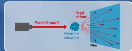
La diffrazione dei raggi X è una tecnica sperimentale fondamentale per determinare la struttura tridimensionale dei materiali. Ad esempio, illuminando un cristallo con un fascio di raggi X, essi, interagendo con gli atomi che compongono il campione, vengono diffratti, ovvero deviati in direzioni specifiche. La figura risultante contiene informazioni dettagliate sulla disposizione degli atomi nello spazio.
